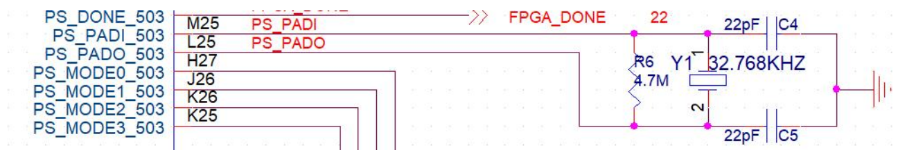
图 2-6-2 RTC 的无源晶振
